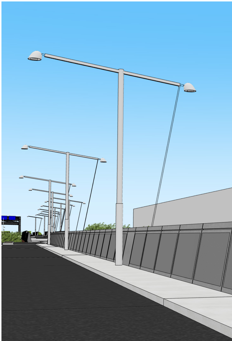
verlichtingsmast in het schampstrook Emmaviaduct richting Julianaplein
