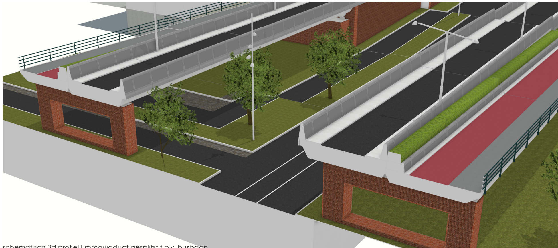
schematisch 3d profiel Emmaviaduct gesplitst t.p.v. busbaan
