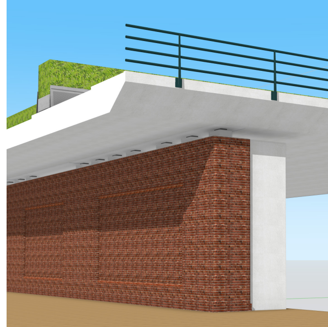
detail wand met oplegging - overgang naar bestaand
