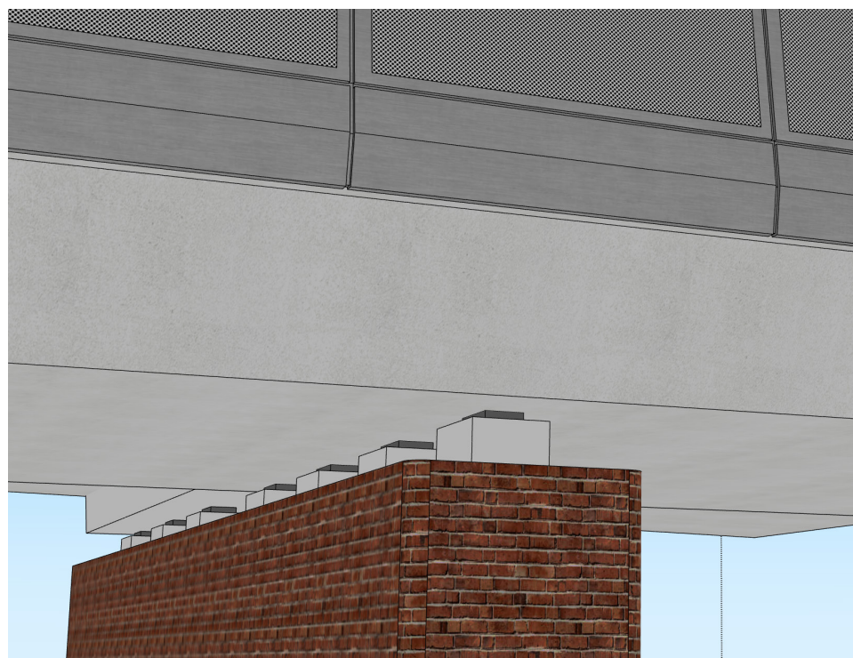
principe oplegging 2 viaductdelen met verschillende dikte en alignement
