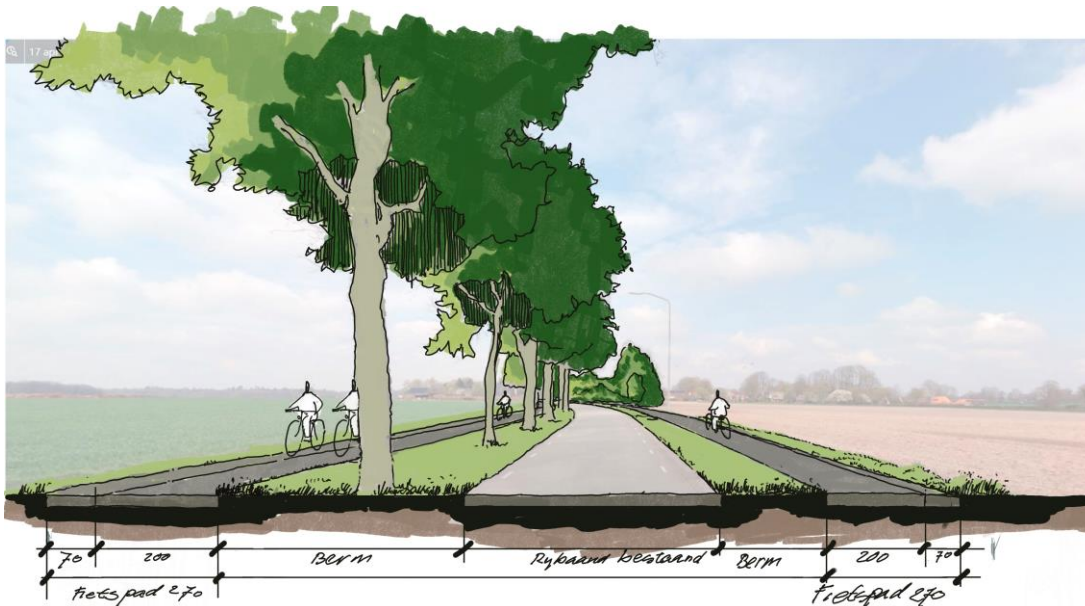
G2. Bredere fietspaden langs de Zuidlaarderweg/Groningerstraat
