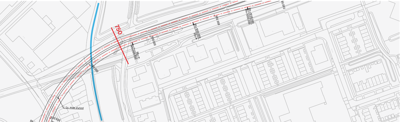
Alignment aquaduct (horizontaal) met indicatie van maaiveldniveau (rood) en locatie Hunze (blauw) *
