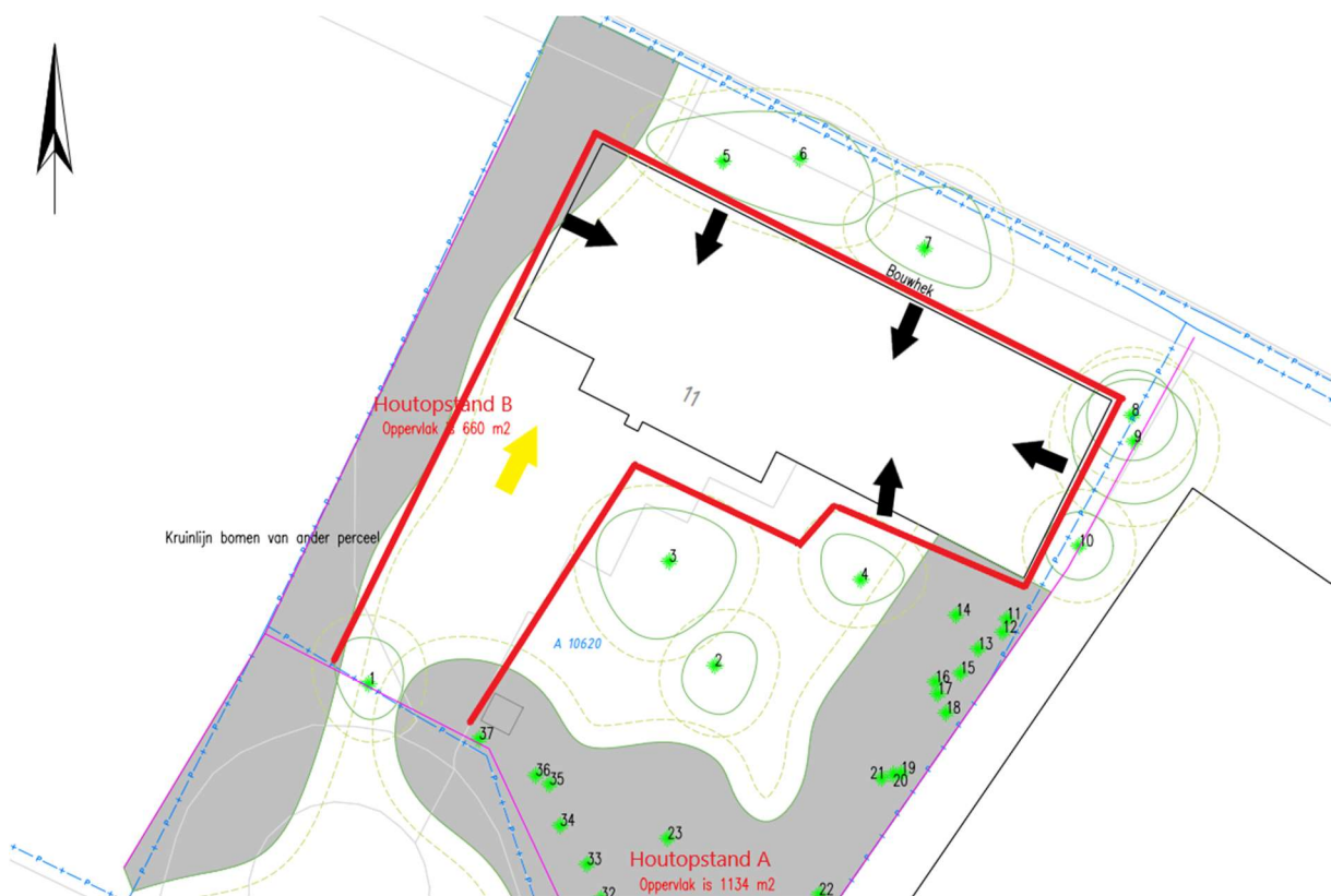
Afbeelding 13; Hekkenplan t.b.v. sloopwerkzaamheden
