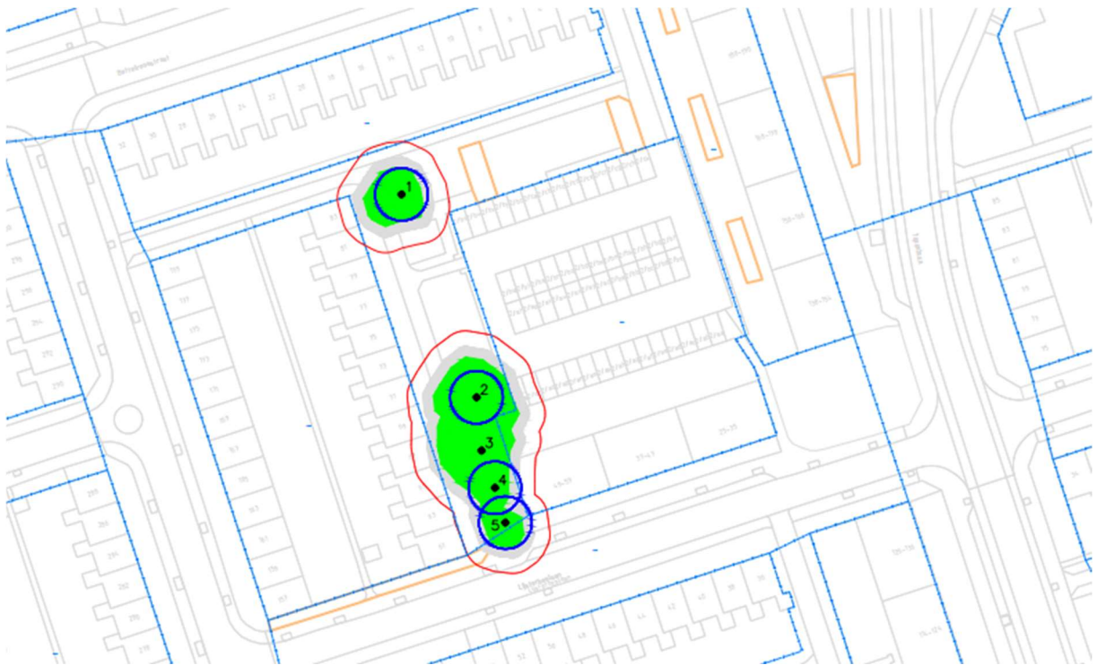
Afbeelding F: detail inmeting bomen heersende situatie (houtopstand, stampositie, boomnummer, kroonprojectie (groen), kroonprojectie +2 m (grijs) en kroonprojectie +5 m (rood))
