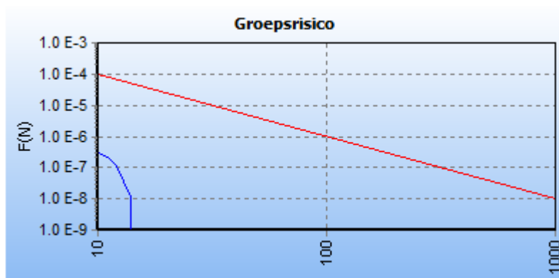
Figuur 19 fN-curve maatgevend km buisleiding
