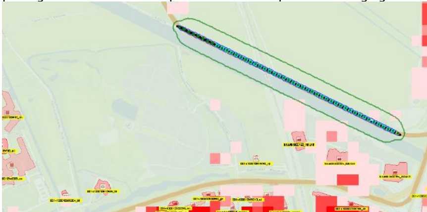
Figuur 4: Overzicht invoer RBMII en inzicht in plaatsgebonden risico 10^{-8} in het groen
