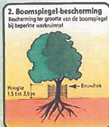
2. Boomspiegel-bescherming Bescherming ter grootte van de boomspiegel bij beperkte werkruimte!
