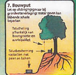
7. Bouwpoot Let op uitdrogingsgevaar bij grondwaterverlaging! Water geven kan bijvliegende schade beperken. Taludbescherming vastzetten met palen en balken.
