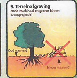
9. Terreinafgraving Hout machinaal ontgraven binnen kroonprojectie!
