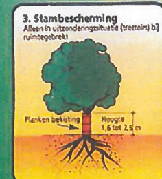
3. Stambescherming Alleen in uitzonderingsituatie (trottoir) bij ruimegebrek!
