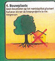
4. Bouwplaats Geen bouwketen op het wortelpakket plaatsen! Parkeert binnen de kroonprojectie is niet toegestaan!
