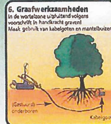
6. Graafwerkzaamheden In de wortelzone uitzend volgens voorschrift in handkracht graven! Maak gebruik van kabelgoten en mantelbuiten.
