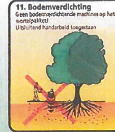
11. Bodemverdichting Geen bodemverdichtende machines op het wortelpakket! Uitsluitend handarbeid toegestaan.
