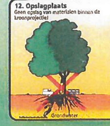
12. Opslagplaats Geen opslag van materialen binnen de kroonprojectie!
