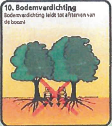
10. Bodemverdichting Bodemverdichting leidt tot afsterfing van de boom!
