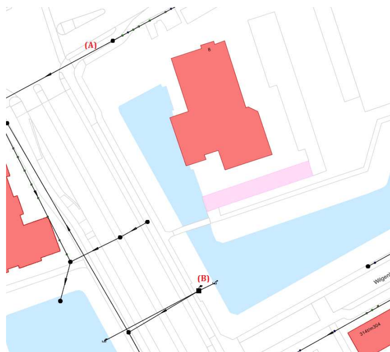
Situatie bestaande riolering
