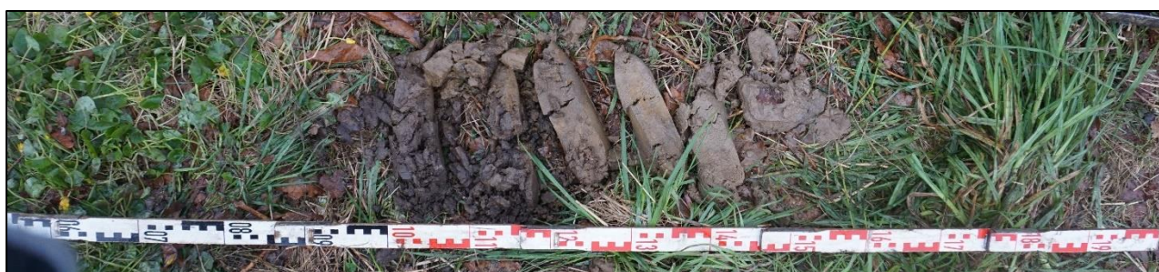
Foto 4: Weergave resultaat profielboring in profielsleuf B vanaf 1m -mv tot 1,6m -mv.
