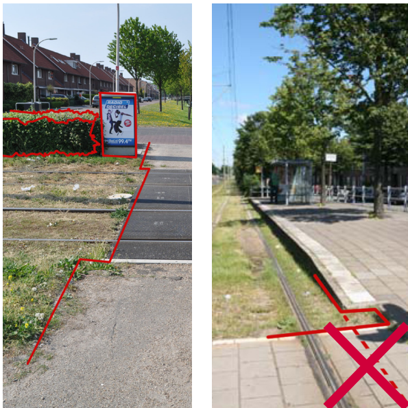
oversteek sluit niet direct aan op oversteekplaats
