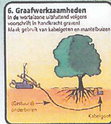
6. Graafwerkzaamheden In de wortelzone uitsluitend volgens voorschrift in handkracht graven! Maak gebruik van kabelgoten en mantelbuisen
