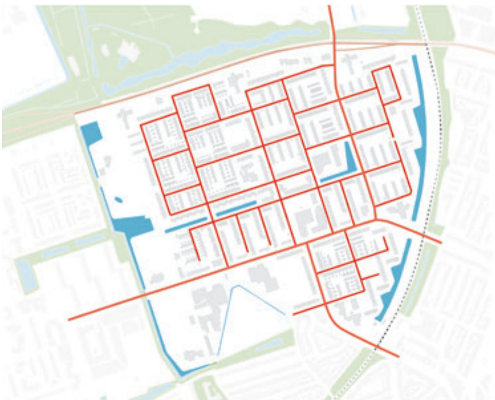
Analyse verkeer: De rechtlijnige structuur van de stempelwijk is perfect voor de automobilist: de wegen zijn recht en het verkeer wordt verspreid omdat er veel routes zijn om van A naar B te komen. Dit resulteert in hardrijdend verkeer, en daardoor onveilige verkeerssituaties voor voetgangers en fietsers.
