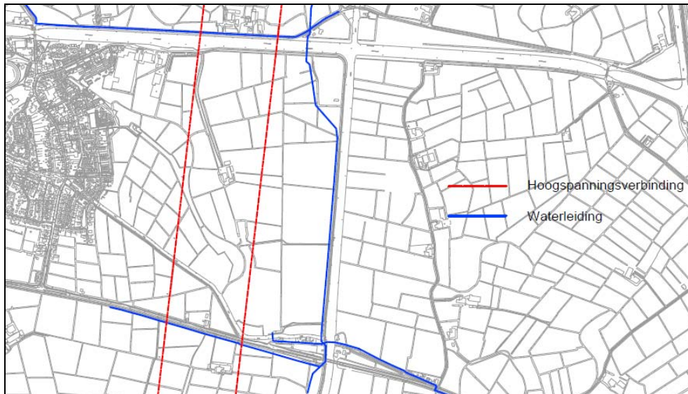
Figuur 33. Ligging hoofdwaterleiding en hoogspanningsverbindingen
