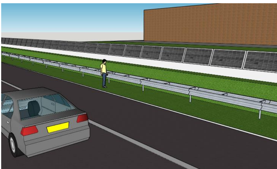
Figuur 6: Zij aanzicht van het 3D model van de energieopwekkende geluidsschermen (op de grondwallen) langs de noordzijde van de snelweg A7 bij Groningen.
