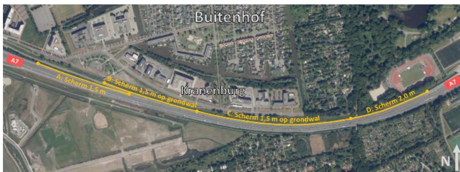
Figuur 3: Aanleg van geluidsschermen langs de noordzijde van de snelweg A7 om de geluidsbelasting te beperken tot maximaal 50 dB in de wijk Buitenhof.
