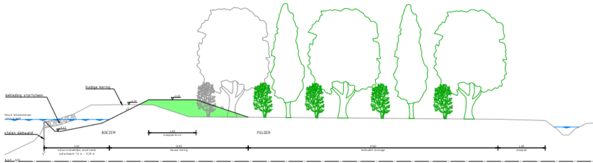
Afbelding 7.3: Ruimtebeslag voor de combinatie van een NVO en de kadeverhoging zonder doorfietsroute.
