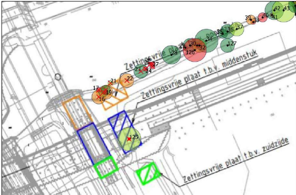
Afbeelding 11: De zettingsvrije platen, en de werkzaamheden die daarbij gepaard gaan, zorgen ervoor dat 13 bomen niet behouden kunnen blijven. Deze zijn bovenstaand weergegeven met een rood kruis.
