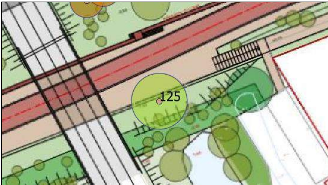
Afbeelding 10: Boom 125 komt zeer dicht op het te realiseren trottoir te liggen. De impact op het ondergrondse ruimtegebruik is hierdoor groot.
