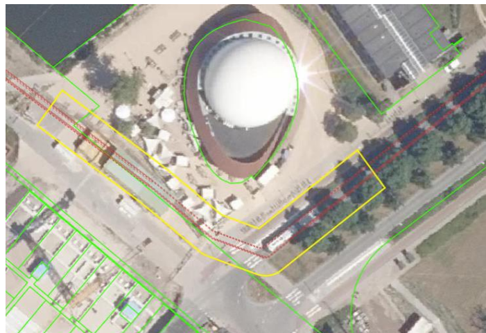
Figuur 1 Specifieke 0,4μT magneetveldzone bij DOT Groningen
