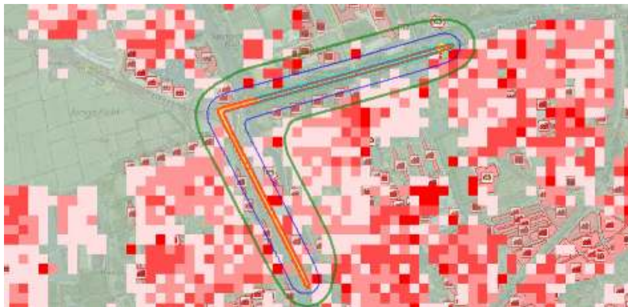
Figuur 5: Overzicht invoer RBMII en inzicht in plaatsgebonden risico 10^{-8} in het groen
