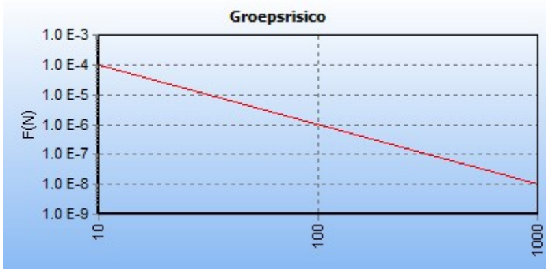
5.7 Figuur 5.7 FN curve voor 7677_leiding-N-507-25-deel-1 van N.V. Nederlandse Gasunie voor de kilometer tussen stationing 0.00 en stationing 600.00
