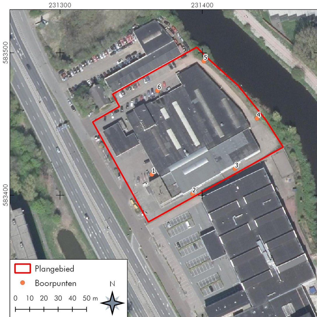
Figuur 9: Groningen, Friesestraatweg 229-231: Locatie van de boringen. De boringen zijn rondom de huidige autogarage gezet. Bron: Publieke Dienstverlening op de kaart.
