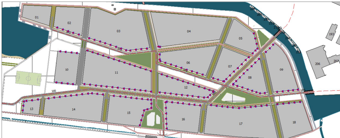
Afbeelding 3: Rekenmodel 'Bestemmingsplangebied deel noord', waarbij de geluidbelaste eerste-lijnsbebouwing van de bouwblokken 1 t/m 9 en 11 t/m 16 op een afstand van 5 m verder van de weg is gesitueerd
