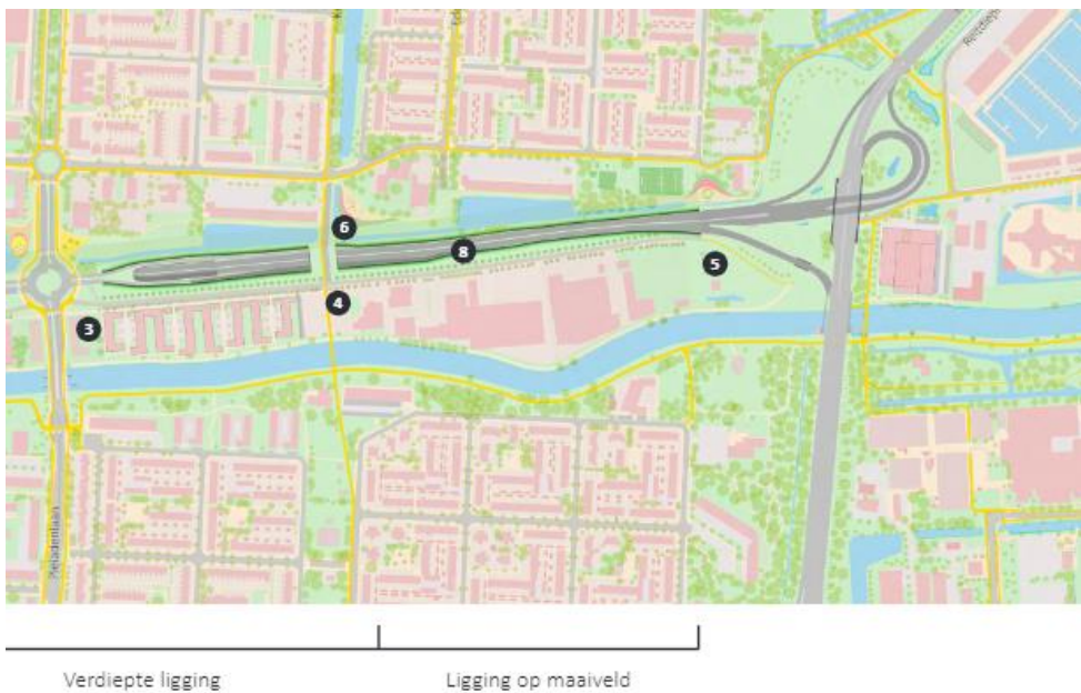
Figuur 2.3 | Ongelijkvloerse kruising Pleiadenlaan en gedeeltelijke asverschuiving (10 – 15 m) ter hoogte van Reijndiepzone Noord
