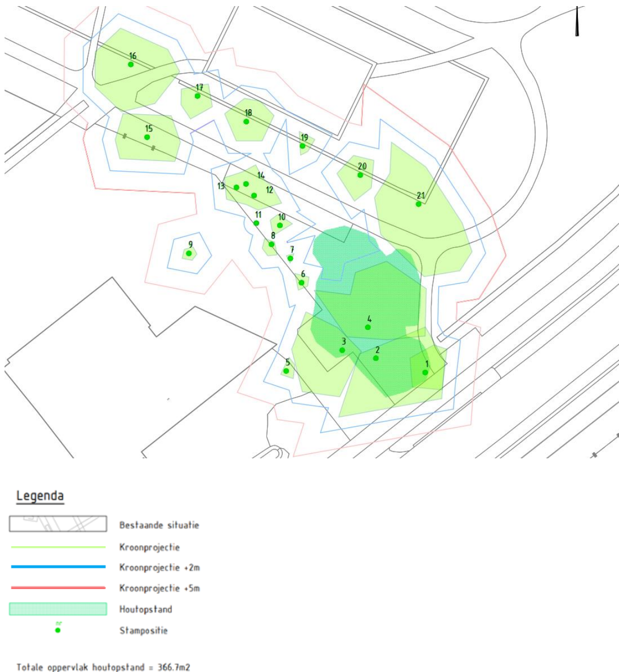
Afbeelding E: bestaande situatie met boomnummering, kroonprojecties + 2 en + 5 m lijn en houtopstand
