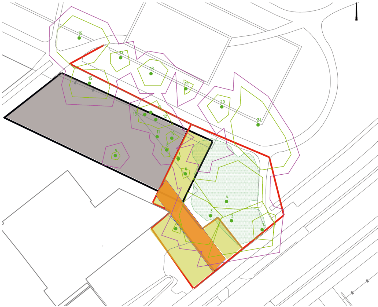
Afbeelding N: kroonprojecties + 2 m met beschermde boomzone/hekkenplan (rood), geadviseerde verkleining van het bouwvlak (grijs), entree voorzien van drukverdelend systeem (oranje) en optionele toepassing van honingraatstructuur behoeve van parkeren en verbetering groeiplaatsomstandigheden (geel)
