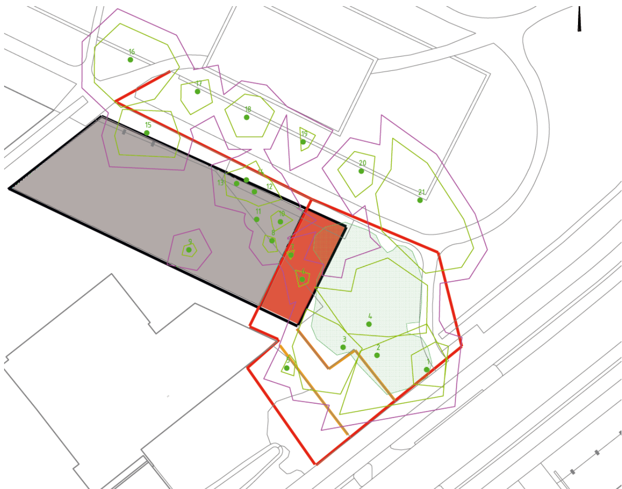
Afbeelding J: kroonprojecties + 2 m met beschermde boomzone/hekkenplan (rood), geadviseerde verkleining van het bouwvlak (grijs) en entree (oranje)
