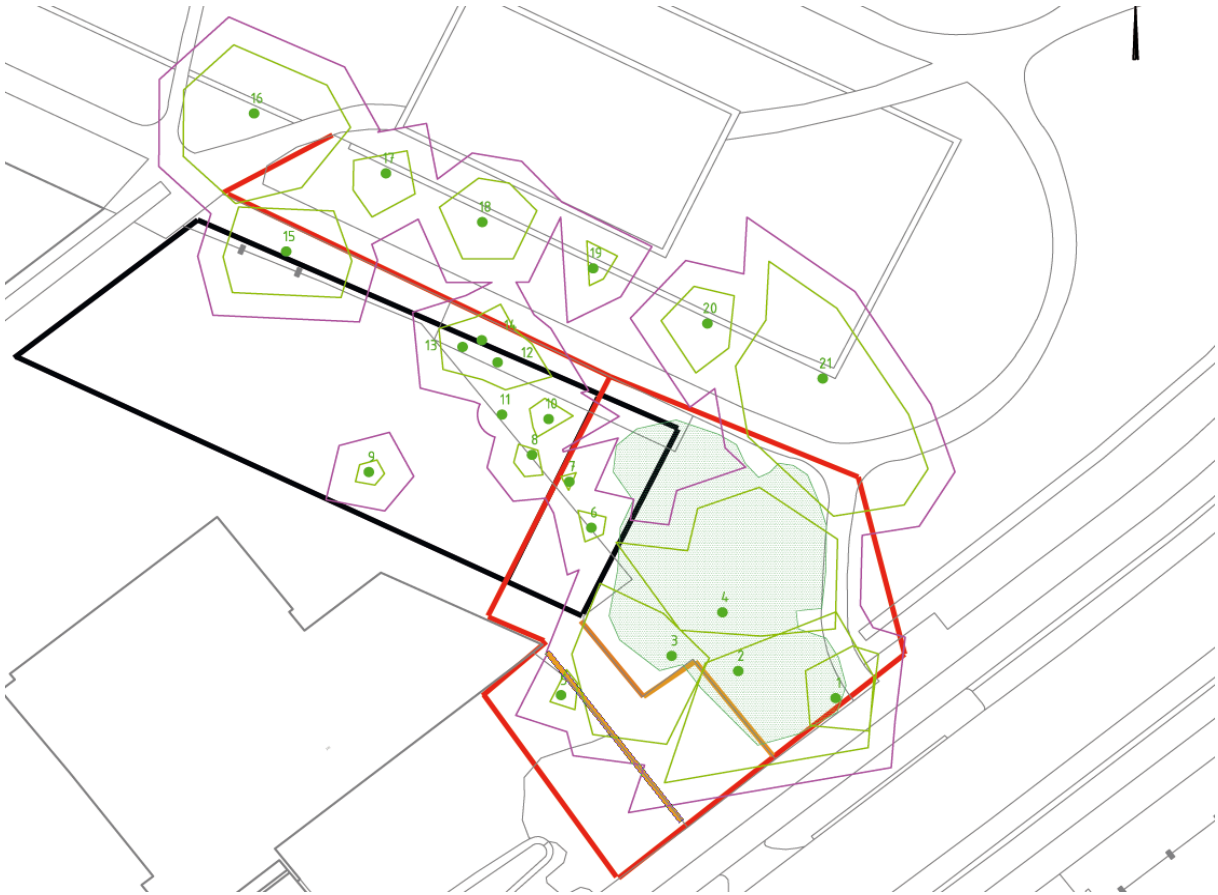
Afbeelding H: kroonprojecties + 2 m met beschermde boomzone/hekkenplan (rood), bouwvlak (zwart) en entree (oranje)
