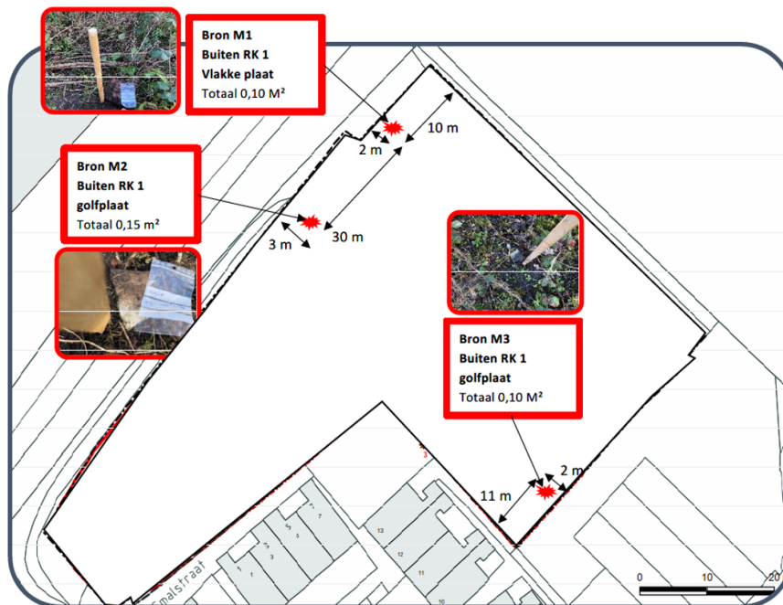
Figuur 4.3 Projectlocatie aangetroffen asbesthoudend plaatmateriaal (bron: Quales Inspections 2019)
