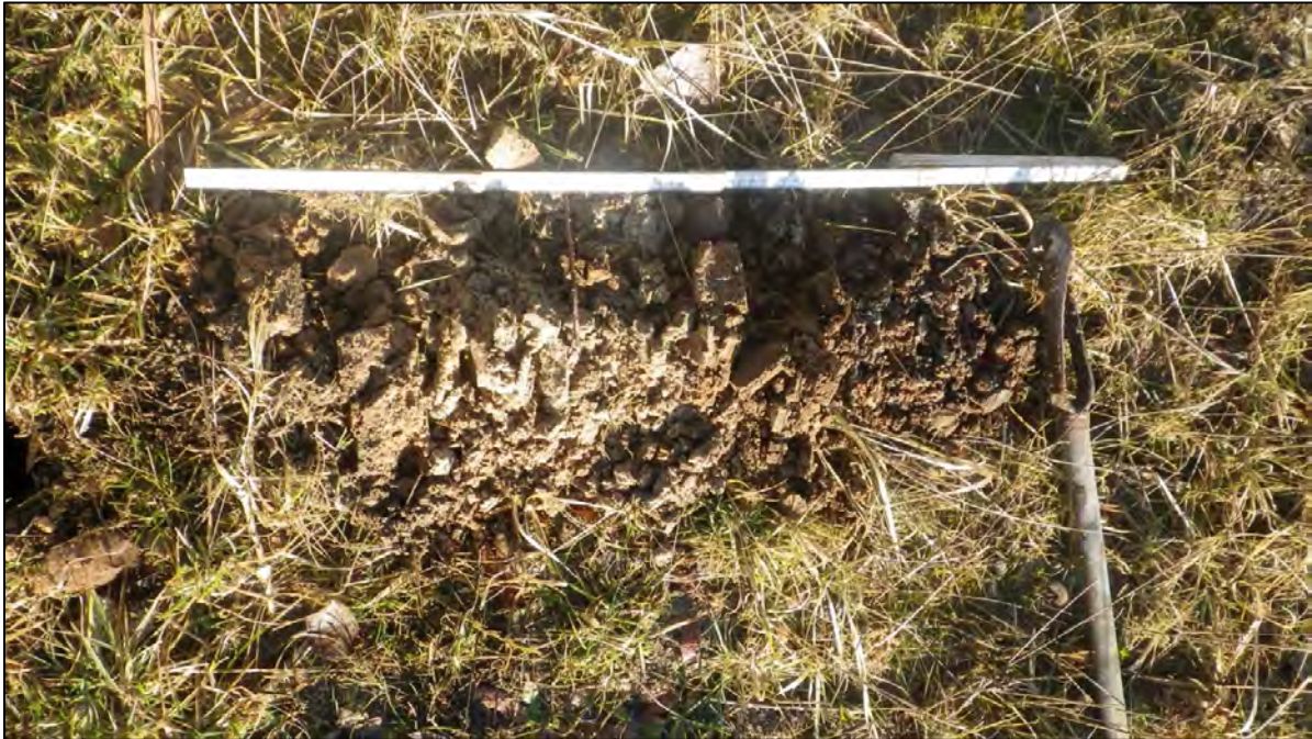
Afbeelding 6. Boring 5. Onder de bruine bouwvoor bevindt zich een pakket opgebracht geel vulzand. De boring werd gestaakt op een (beton)vloer
