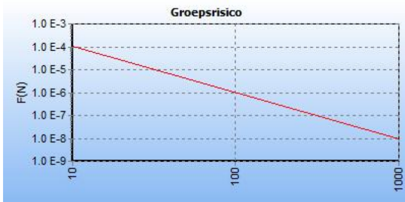
Figuur 8: FN curve voor N-508-01 van N.V. Nederlandse Gasunie voor de kilometer tussen stationing 0.00 en stationing 1000.00
