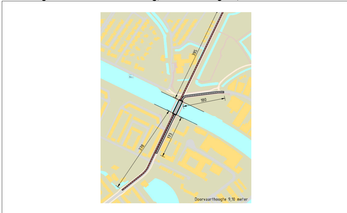
Afbeelding 3.2. Variant 3: Enkele brug, doorvaarthoogte 9,1 m
