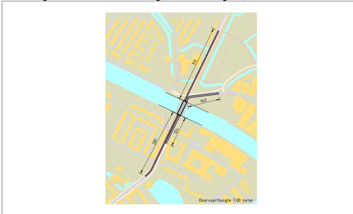
Afbeelding 3.1. Variant 2: Enkele brug, doorvaarthoogte 7,0 m 1
