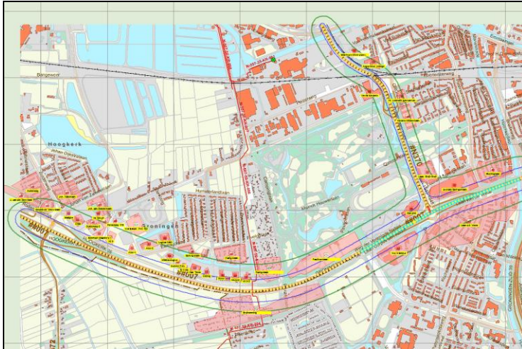
Figuur 12: modelomgeving RBM berekening N370 en A7 en Carola berekening gasleiding N-507-50
