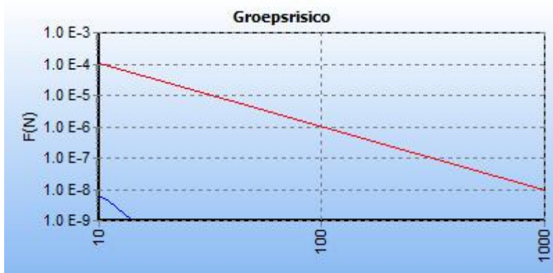
Figuur 3: FN curve voor N-507-27 van N.V. Nederlandse Gasunie voor de kilometer tussen stationing 0.00 en stationing 220.00, nieuwe situatie
