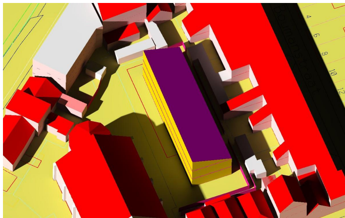
Zonnediagram (vanuit het oosten) van de situatie op 21 maart om 10.00 uur bij een goothoogte van 7 meter en een nokhoogte van 11 meter
