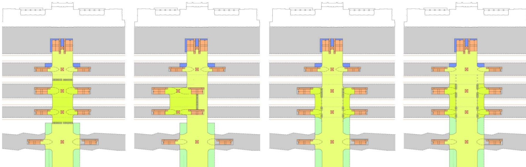
Verkenning varianten OVCP, met rechts de voorkeursvariant (3 traveeën over de gehele lengte van de passage)
