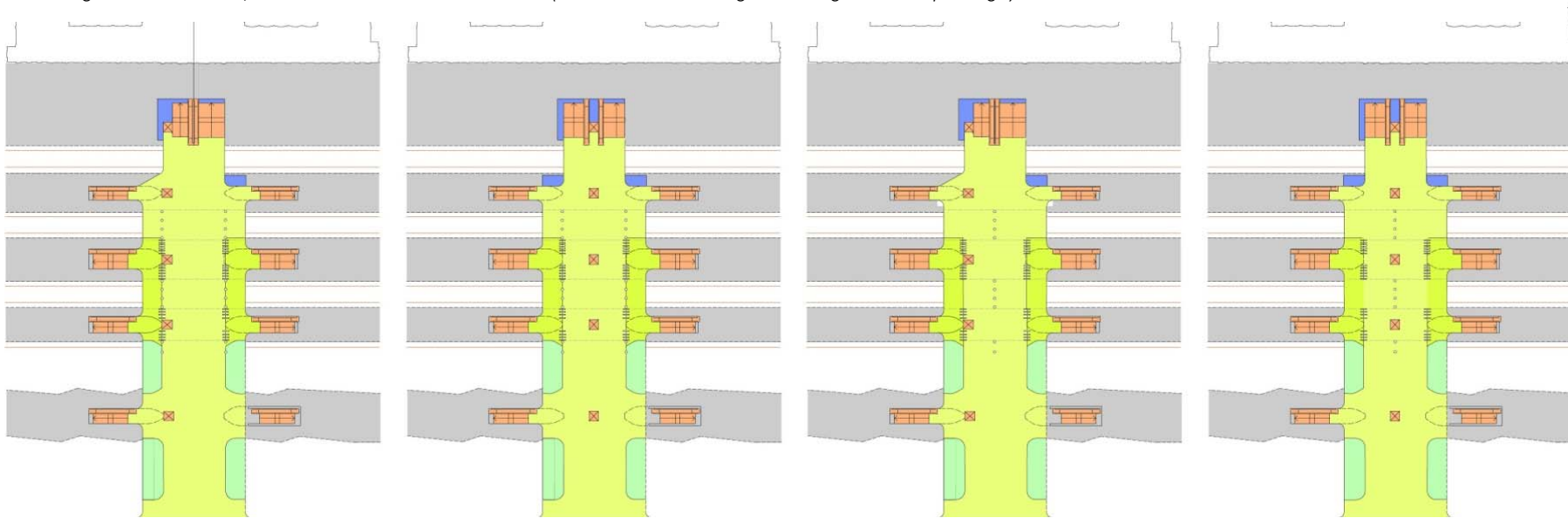
Verkenning verschillende posities (in het midden, aan de zijkanten) voor kolommen en voor liften in de voorkeursvariant, voornamelijk heeft het schema links de voorkeur.
