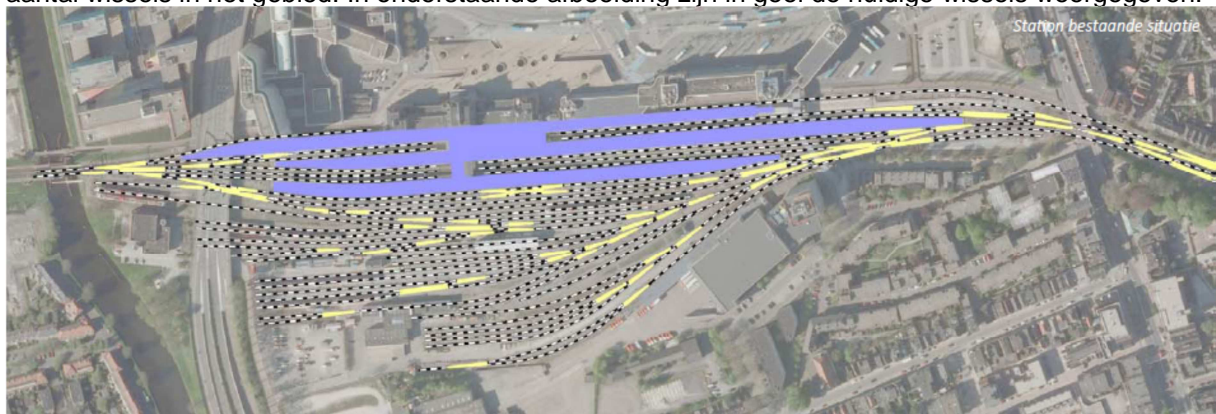
Afbeelding 8: Huidige spoorconfiguratie met in blauw de huidige perron en in geel de huidige wissels.
