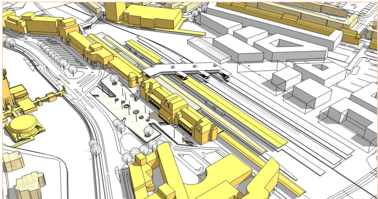
Afbeelding 3: Transfer middels passerelle schuin over de sporen.
