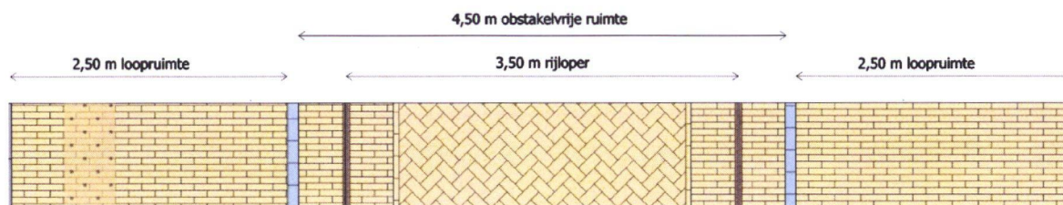
Principe van de hybride zone tussen rijloper en loopruimte met bijbehorende maten.
