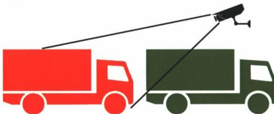
Figuur 3.1 Detectie problemen door plaatsing camera in combinatie met voertuigintensiteit
