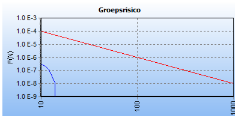
Figuur 19 fN-curve maatgevend km buisleiding
