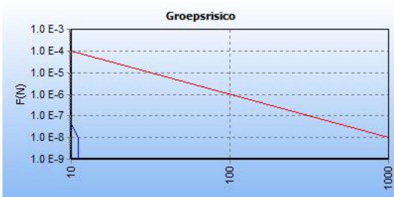
5.8 Figuur 5.8 FN curve voor 1432_leiding-N-507-32-deel-1 van N.V. Nederlandse Gasunie voor de kilometer tussen stationing 0.00 en stationing 80.00
