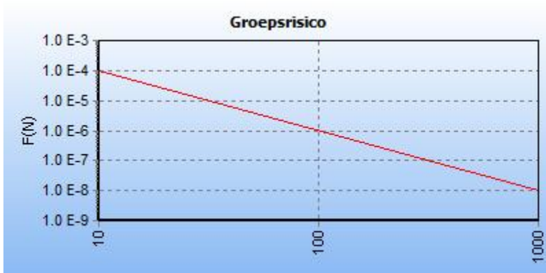
5.10 Figuur 5.10 FN curve voor 1432_leiding-N-507-51-deel-1 van N.V. Nederlandse Gasunie voor de kilometer tussen stationing 0.00 en stationing 60.00
