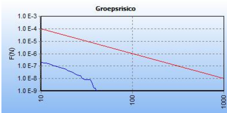
5.10 Figuur 5.10 FN curve voor 1432_leiding-N-507-51-deel-1 van N.V. Nederlandse Gasunie voor de kilometer tussen stationing 0.00 en stationing 60.00
