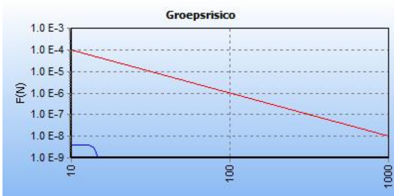
5.7 Figuur 5.7 FN curve voor 1432_leiding-N-507-30-deel-1 van N.V. Nederlandse Gasunie voor de kilometer tussen stationing 18580.00 en stationing 19490.00
