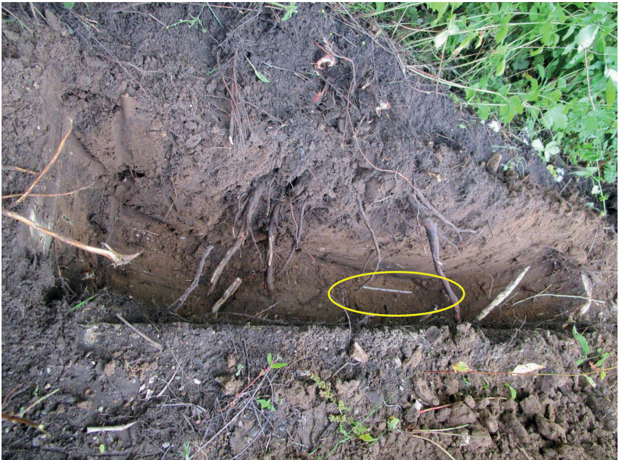
Beeld van de beworteling in proefsleuf en leiding (geel omlijnd)
