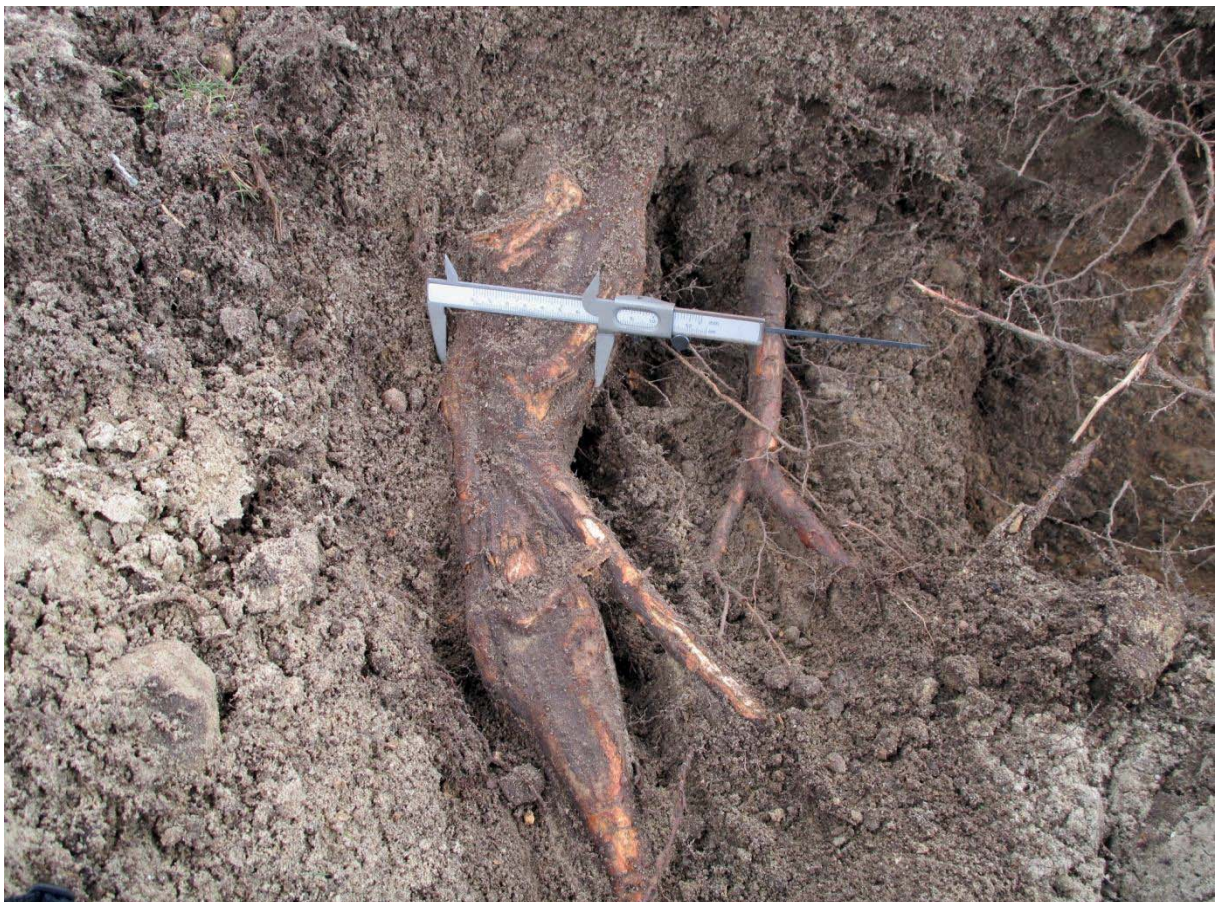
Beeld van platgedrukte stabiliteitswortel (ca. 9 cm) direct onder de bestrating
