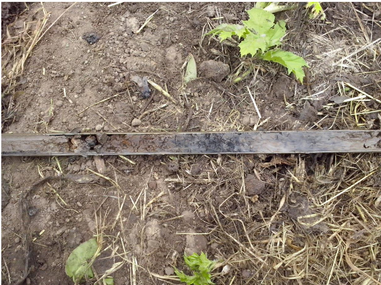
Figuur 13: Foto van boring 1 met daarin de brokkelige kleilaag (links) het dunne laagje sterk veraard veen (midden) en de daarboven gelegen klei met brandlaagjes (de grijze band met dunne zwarte lijntjes en vlekjes rechts op de foto).
