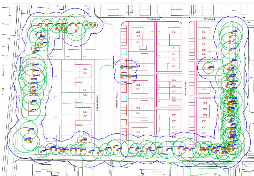
Weergave van de kroonprojectie met een buffer van 5m in blauwe belijning.
