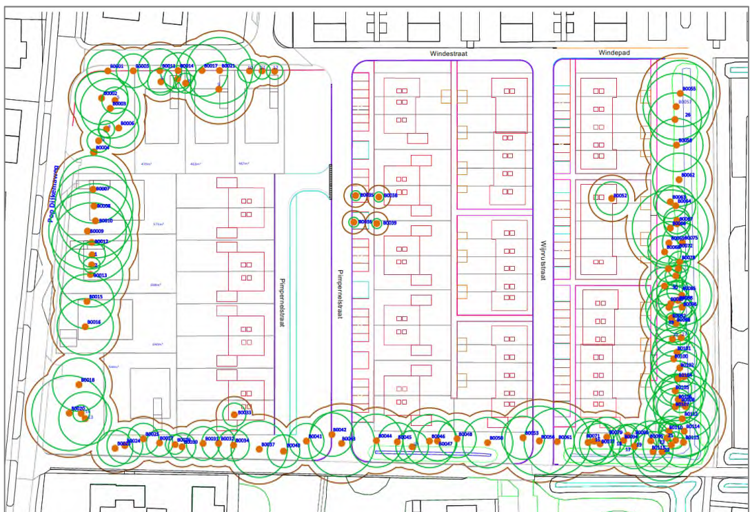
Weergave van de kroonprojectie met een buffer van 2m in bruine belijning
