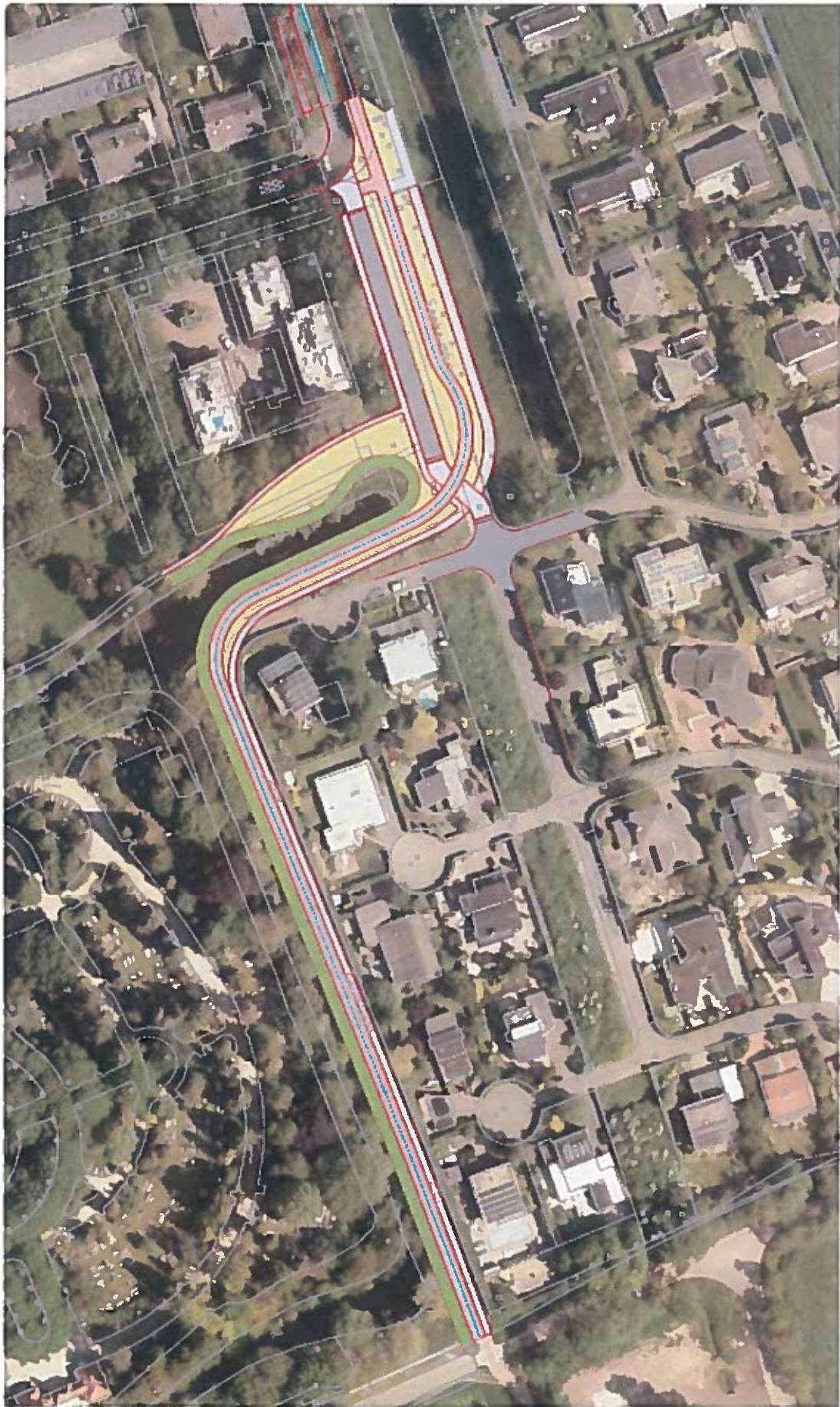
Variant buitenom via Esserhaag (aansluiting oostzijde Helperzoom)
