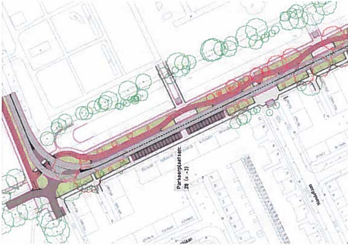
Figuur 3: deel van het ontwerp van een vrijliggend fietspad aan de oostzijde van de Helperzoom.
