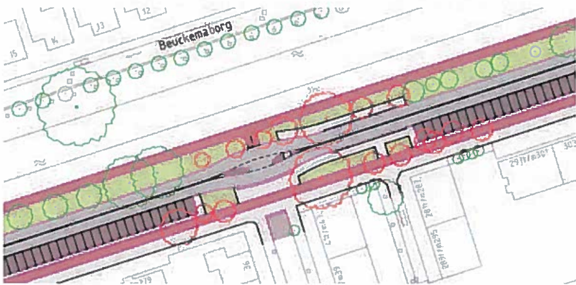
Figuur 14: deel van het ontwerp van een vrijliggend fietspad aan weerszijden van de Helperzoom.
