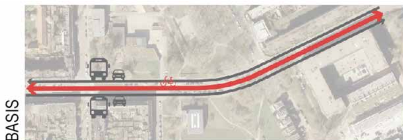
Fiets in het midden, auto en bus via 1 richtingsstraten aan weerszijden
