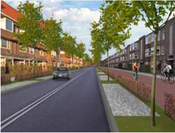
2-richtingsfietspad aan 1 zijde ('asymmetrisch')
