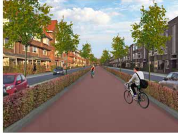
Centraal fietspad met ventwegen aan weerszijden
