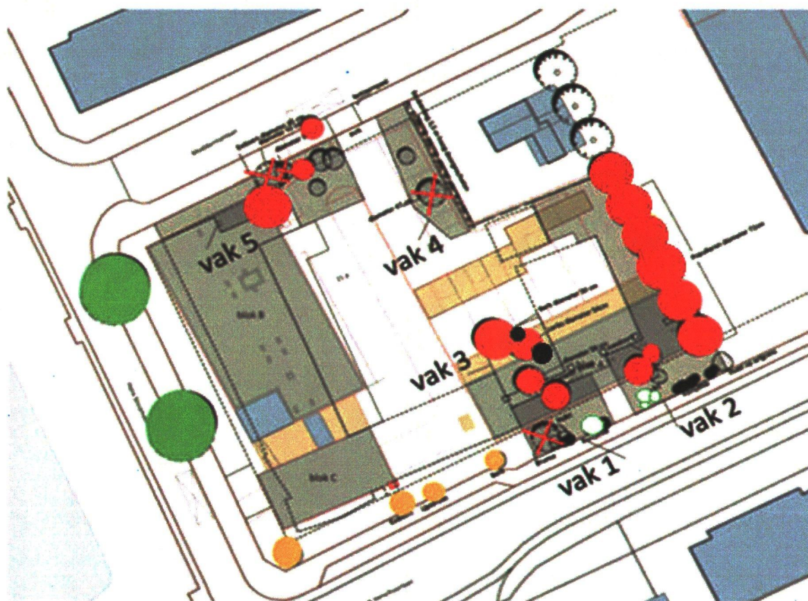
Afbeelding 12: Overzicht effectenanalyse m.b.t. huidig ontwerp (groen = neutraal, oranje = licht negatief en rood is zeer negatief, zwart = reeds verwijderd); de te vellen bomen (gevaarstelling) zijn gemarkeerd d.m.v. een rood kruis
