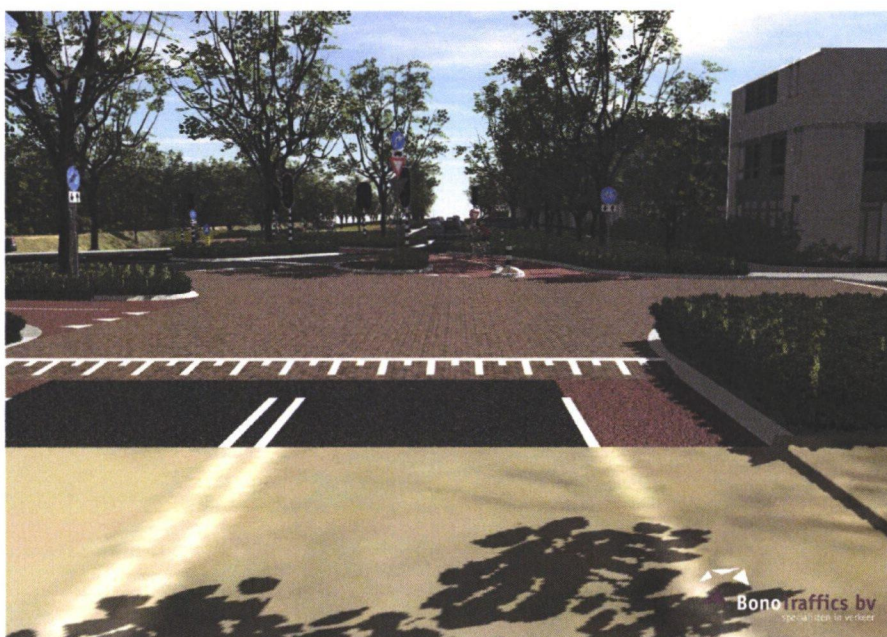
Figuur 3: ontwerp kruising Helper Brink – Helperzoom met fietsers uit de voorrang
