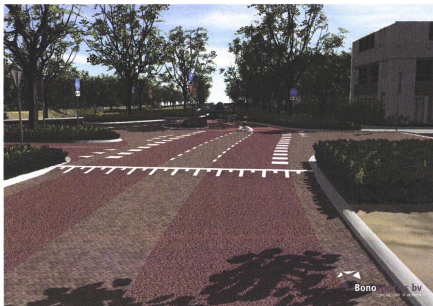
Figuur 2: ontwerp kruising Helper Brink – Helperzoom met fietsers in de voorrang
