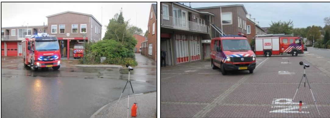
Figuur 4: Bronsterkte bepaald via uitgevoerde geluidsmetingen
