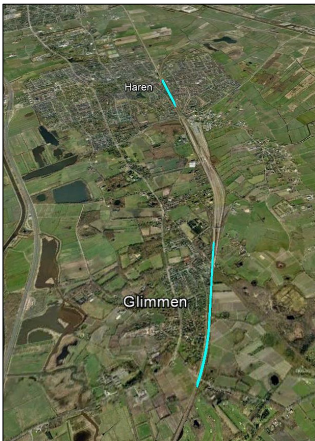
Figuur 11: Geplande plaatsing van raildempers
