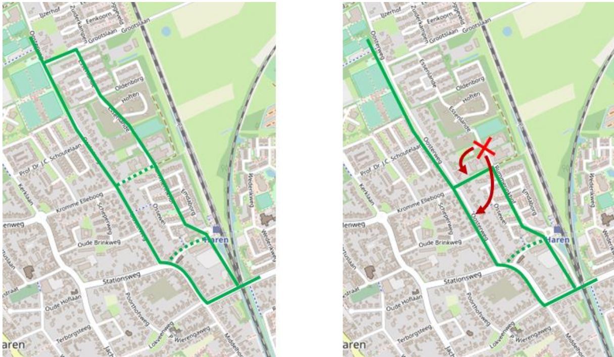
Figuur 3.3 Huidige parallele routes Rummerinkhof en Oosterweg (links) en verschuiving fietsstromen bij vervallen doorsteek (rechts) – situatie zonder fietstunnel
