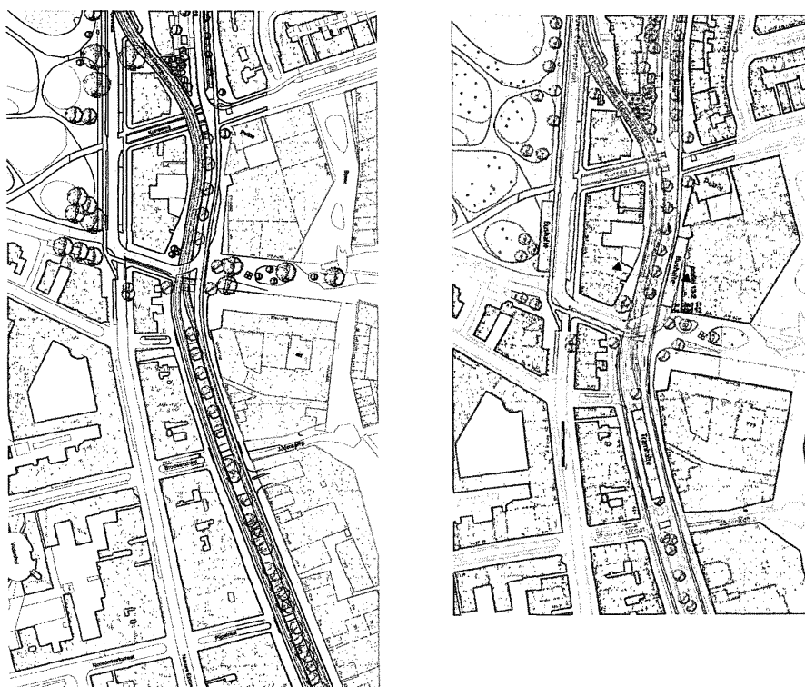
Kaart 10. Inrichting kruispunt Boterdiep/Korreweg en locatie halte Boterdiep, rechts het oorspronkelijke VO (oud) en links het aangepaste ontwerp. Haltes in blauw.
