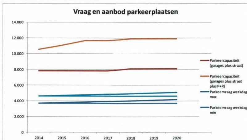
Figuur 15: Ontwikkeling van vraag en aanbod van parkeerplaatsen. De parkeervraag is gebaseerd op de parkeervraag voor parkeergarages binnenstad en schil plus straatparkeren buurt 00 t/m 04, exclusief buurtstallingen en P+R.
