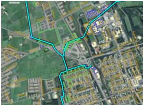
Figuur 4.4 Kilometer leiding behorende bij de maximale overschrijding van de FN-curve voor N-507-31 van N.V. Nederlandse Gasunie
